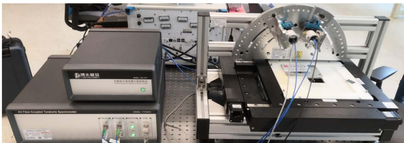
国内某世界 50 强企业：光纤耦合式太赫兹光谱仪+XY 扫描成像台
